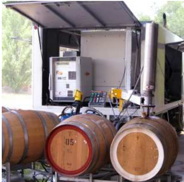
Figure 16 – Nettoyage et désinfection par application d’ultra-sons à haute fréquence Unité mobile autonome de traitement (procédé Cavitus, Wine Barrel Cleaning Services, Barossa Valley (Australie))
