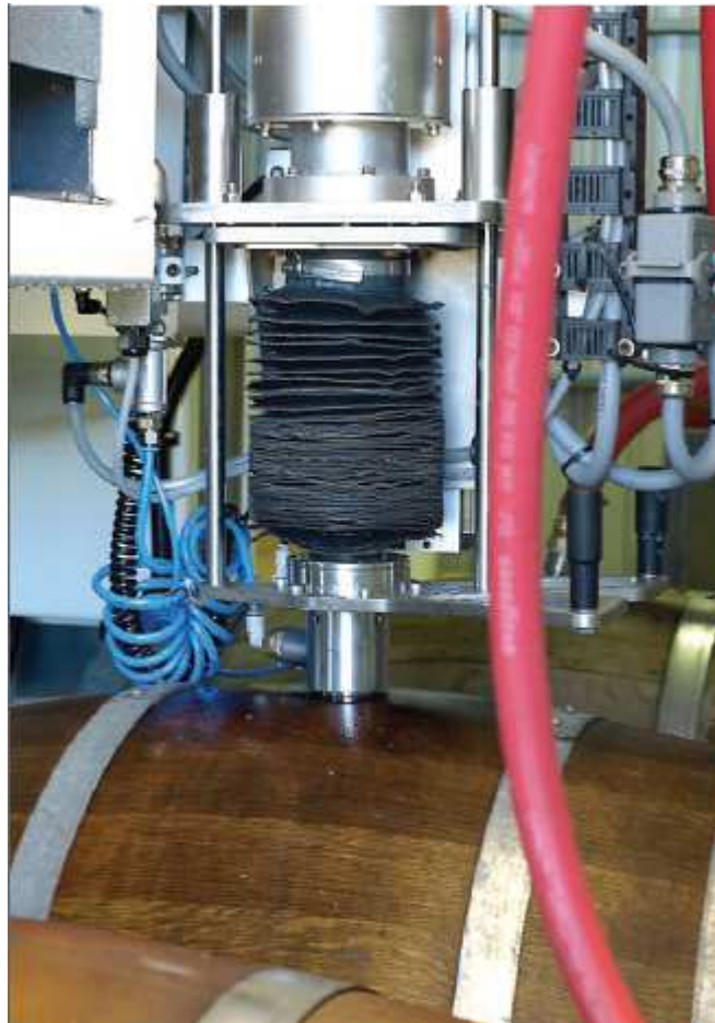
Figure 15 – Introduction de la sonotrode dans une barrique selon le procédé Cavitus pour son reconditionnement sur un dispositif automatique
