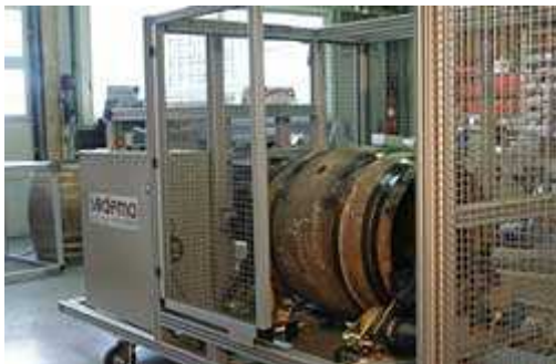
Figure 14 – Technique de rabotage automatique des douelles de barriques usagées par la technique BACCHUS de SODEMA (17800 Salignac, France)
