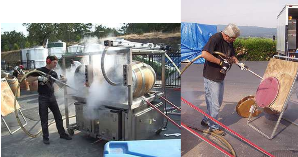
Figure 19- Procédé de nettoyage cryogénique des barriques à la neige carbonique
