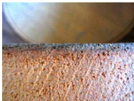
Figure 18 – Aspect de la douelle après nettoyage par sablage selon le procédé BARENA (33810 Ambes, France) dérivé du procédé BRUNATEAU (40990 St Paul les Dax, France)
