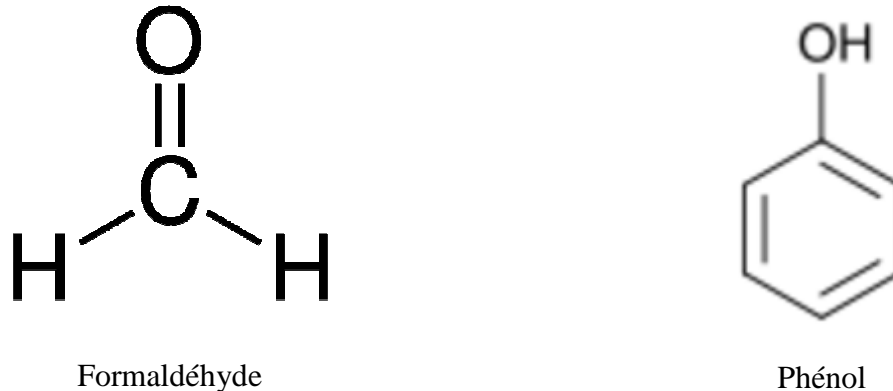
Figure 1 – Structure du phénol et du formaldéhyde émis par les systèmes de collage des panneaux agglomérés à base de bois
